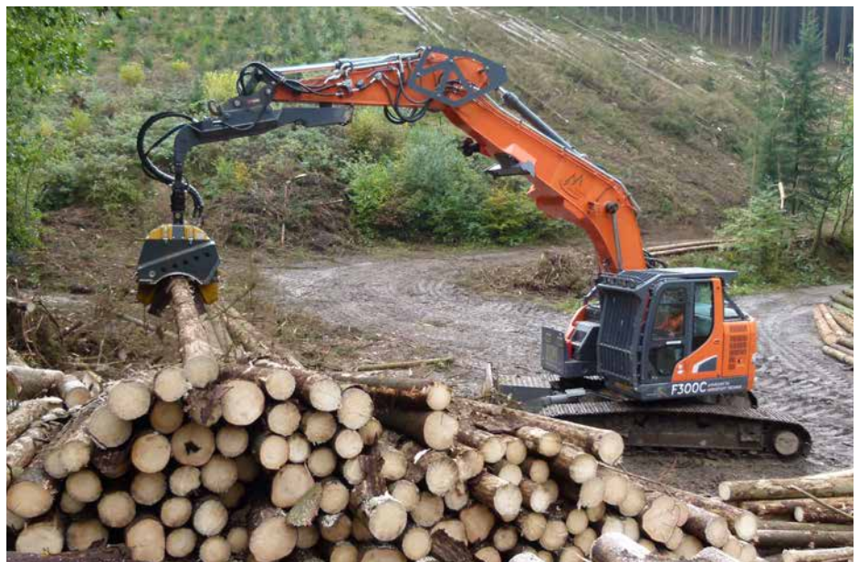
Beim Aufarbeiten von Langholz auf der Waldstrasse. Der F-300-C-Spezialbagger hat 9,5 m Reichweite und bei 6 m Auslenkung (gemessen am Löffelbolzen) eine maximale Traglast von 7,5 t.
