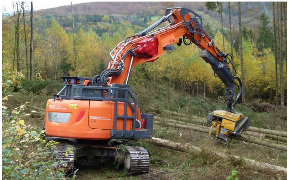
Oben: Verschiedene Schutzverbauten schützen empfindliche Maschinenteile vor möglichen Stammschlägen: Die Adler-Seilwinde mit 16 t Zugkraft am Baggerarm (rot) ist durch einen Schutzverbau geschützt und die Hydraulikleitung durch den seitlichen Stielschutz-Verbau.
